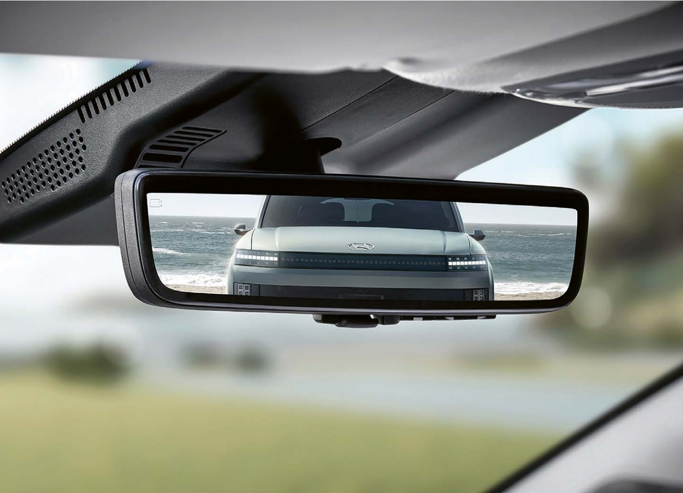
Kada je aktivan, digitalni središnji retrovizor koristi stražnju kameru kako bi projicirao videozapis u stvarnom vremenu na retrovizor za znatno šire vidno polje.
